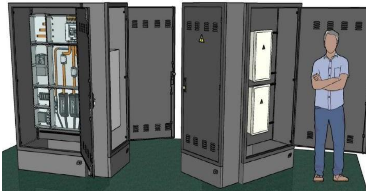
Figura 6. Detall armari prefabricat instal·lació d'enllaç
